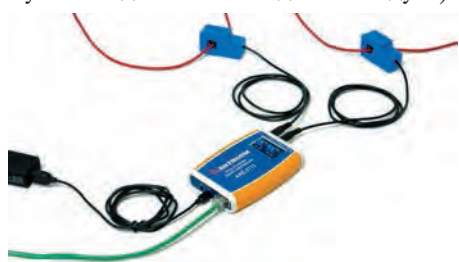
Рис. 4. Универсальный контроллер LAN/USB АКТАКОМ ААЕ-2712 с бесконтактными датчиками тока АМЕ-8821
