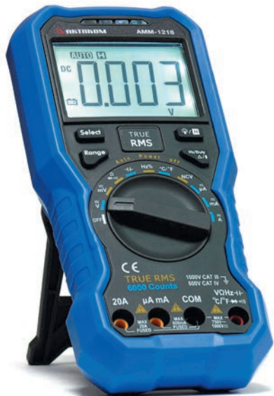
Рис. 8. Цифровой мультиметр с функцией регистратора и интерфейсом Bluetooth АКТАКОМ АММ-1218
