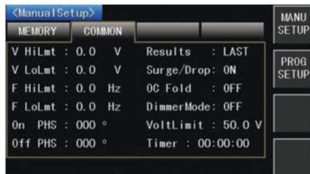
Рис. 6. Меню установки дополнительных параметров
