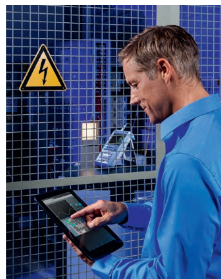
Рис. 9. В потенциально опасных измерениях прибором R&S Scope Rider можно управлять по беспроводной сети прямо из веб-браузера. Источник: Rohde & Schwarz
