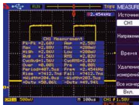
Рис. 13. Табличная форма отображения результатов на экране осциллографов АКТАКОМ АСК-2032...2205
