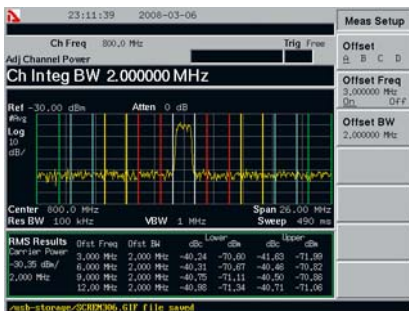
Рис. 8. Измерение мощности в соседних каналах CDMA (4 смещения)
