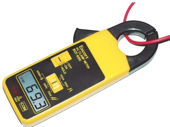
Рис. 1. Внешний вид токовых клещей ЕСТ-650
