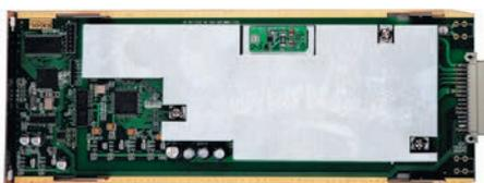
Рис. 5. Внешний вид измерительного модуля MS3065
