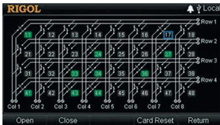
Рис. 11. Интерфейс управления матричным коммутатором МС3648
