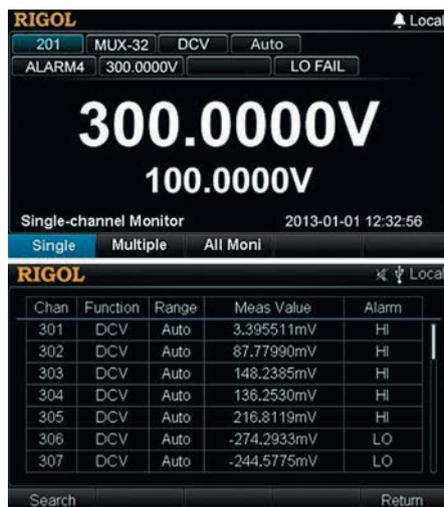
Рис. 16. Режим мониторинга одного канала (сверху) и режим мониторинга нескольких или всех каналов (снизу)
