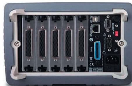
Рис. 3. Вид сзади на базовый блок системы M300 с пятью установленными модулями
