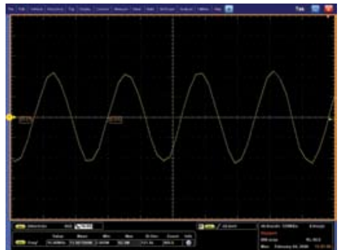
Рис. 27. Недостаточная частота выборки синусоидального сигнала частотой 100 МГц выражается в искажении развертки.
