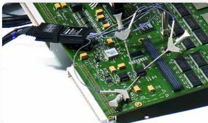
► Рис. 4. Пробник общего назначения
