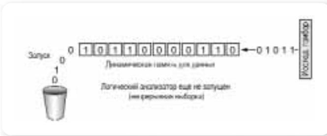
► Рис. 11. Логический анализатор захватывает и отбрасывает данные по принципу «первый на входе – первый на выходе» до тех пор, пока не произойдет событие запуска.
