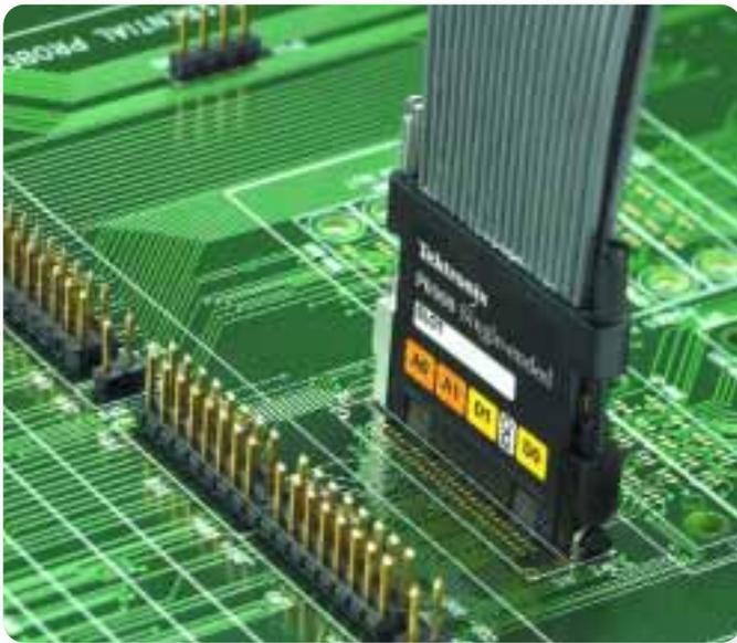
► Рис. 6. Безразъемный пробник анализатора D-Max™
