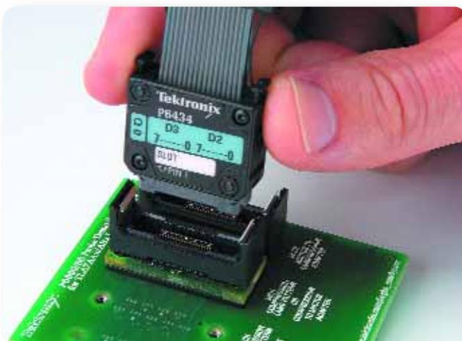
► Рис. 5. Высокоплотный, многоканальный пробник логического анализатора
