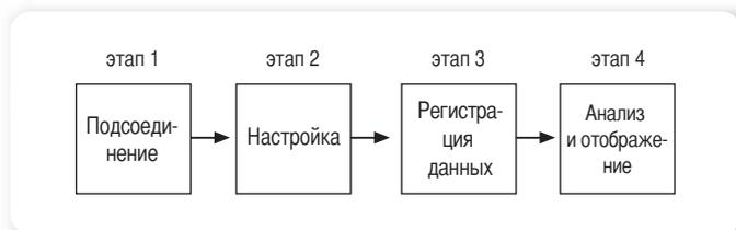
► Рис. 3. Упрощенная схема работы логического анализатора
