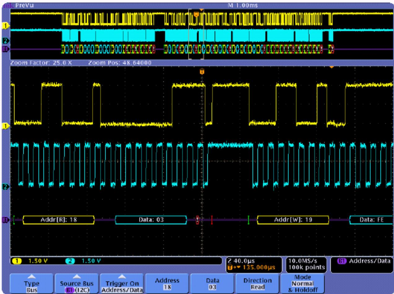
► Рис. 2. Просмотр осциллограммы с записью большой длины для шины I<sup>2</sup>C.
