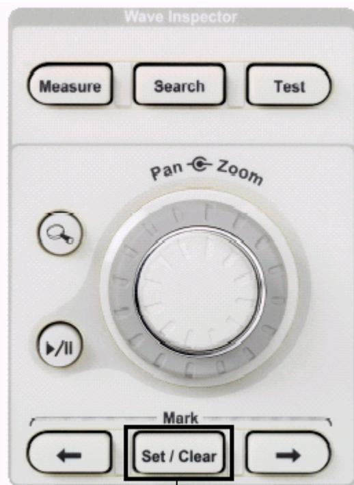
► Рис. 2В. Специальные элементы управления на передней панели позволяют устанавливать маркеры и быстро просматривать их.
