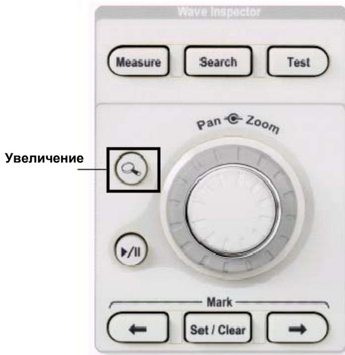
► Рис. 1А. Wave Inspector с элементами управления масштабированием и панорамированием на передней панели.
