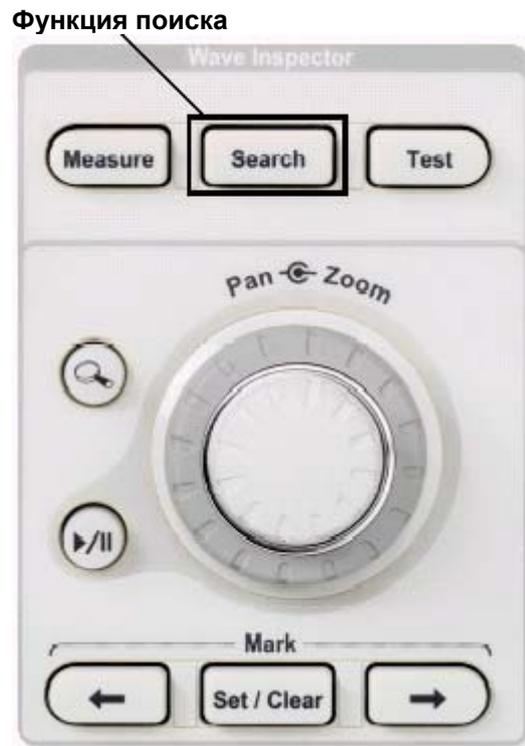
► Рис. 3А. Эффективная функция поиска, предоставляемая Wave Inspector, позволяет находить в зарегистрированной осциллограмме все заданные пользователем события.
