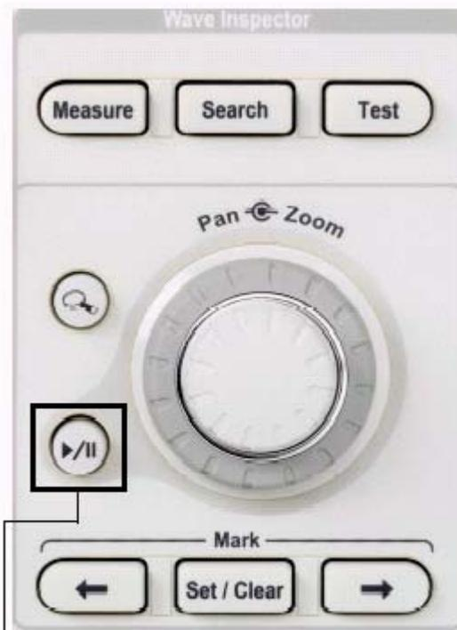
► Рис. 2А. Специальный элемент управления на передней панели для автоматического перемещения осциллограммы
