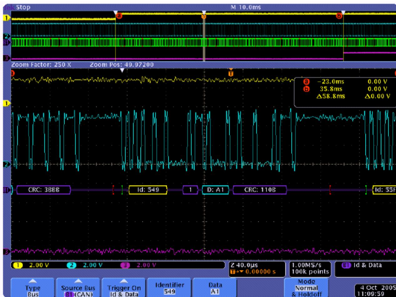
► Рис. 3. Установка маркеров на осциллограмме при измерении задержки в шине CANbus.
