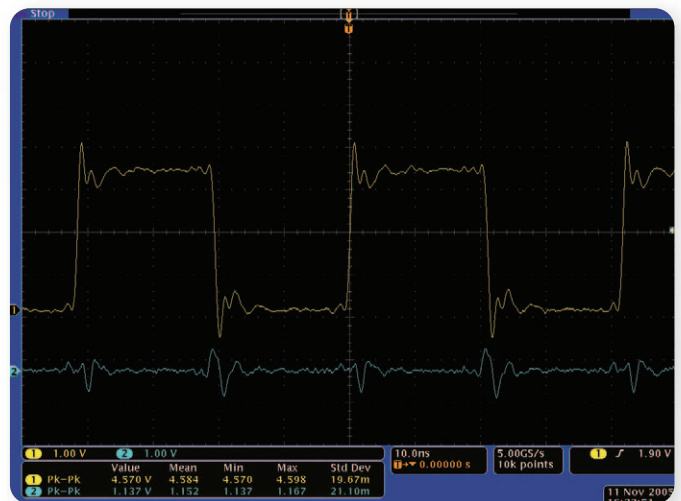
► Рис. 2. Колебания в шине заземления при переключении выхода на канале 1.
