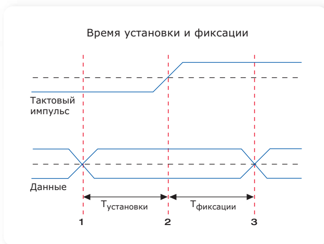
► Схема 2. На этой схеме дано определение времени установки ( T_{установки} ) и времени фиксации ( T_{фиксации} ) для тактируемой логической схемы. Время установки измеряется между точками 1 и 2. Время фиксации измеряется между точками 2 и 3.
