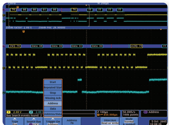
► Рис. 8. Синхронизация осциллографа DPO4000 по шине I 2 C осуществляется по выбранному адресу (76) для чтения или записи. Автоматическое декодирование каждого пакета устраняет необходимость в ручном декодировании, снижает вероятность ошибки и экономит время.
