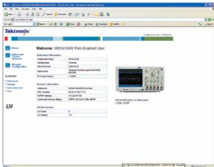
Веб-интерфейс LXI предоставляет доступ к сетевым настройкам, обеспечивает функции дистанционного управления и передачи данных через стандартный браузер.
