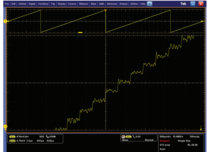
Рис. 19. Увеличенное отображение того же цифрового линейного сигнала высокого разрешения, измеренного на основе большого количества усреднений, отображающего значительно повышенное разрешение по вертикали
