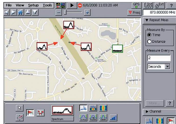
Пеленгация помех с помощью интегрированного картографического решения.
