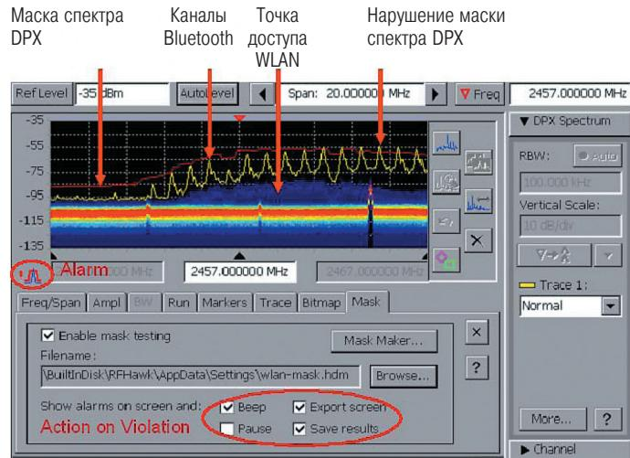
Функция маски спектра DPX позволяет захватывать и регистрировать нарушения спектра с возможностью подачи тревожного сигнала, приостановки теста, экспорта снимка экрана и сохранения результатов.
