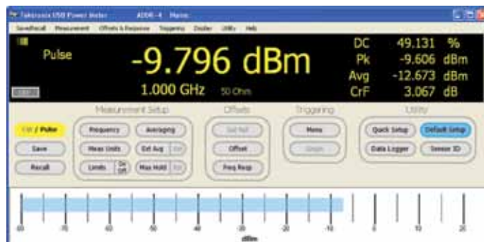
Рис. 8. Прикладное ПО датчика мощности Tektronix, показывающее измерение пиковой и импульсной мощности.
