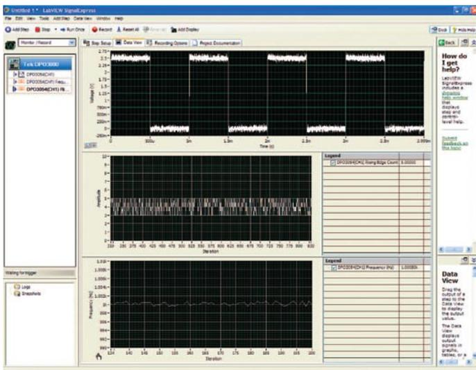
NI LabVIEW SignalExpress™ Tektronix Edition – полностью интерактивное ПО для измерения, захвата и анализа сигналов, разработанное совместно с компанией National Instruments и оптимизированное для осциллографов серии MSO/DPO.
