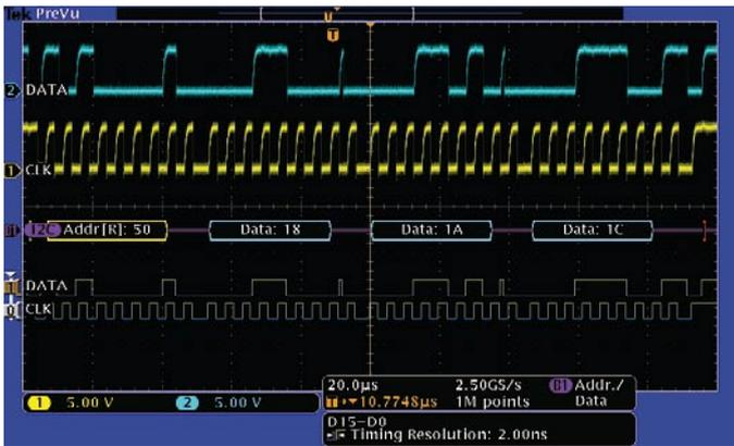
Запуск от конкретного пакета данных, проходящего по шине I<sup>2</sup>C. Желтая осциллограмма представляет собой сигнал тактовой частоты, а синяя – данные. Осциллограмма сигнала шины показывает декодированное содержимое пакета, включая Старт, Адрес, Чтение/Запись, Данные и Стоп.
