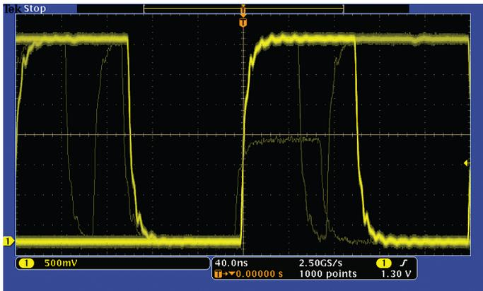
Обнаружение: высокая скорость захвата сигнала – более 50 000 осциллограмм в секунду – максимально повышает вероятность обнаружения кратковременных глитчей и других редко происходящих событий
