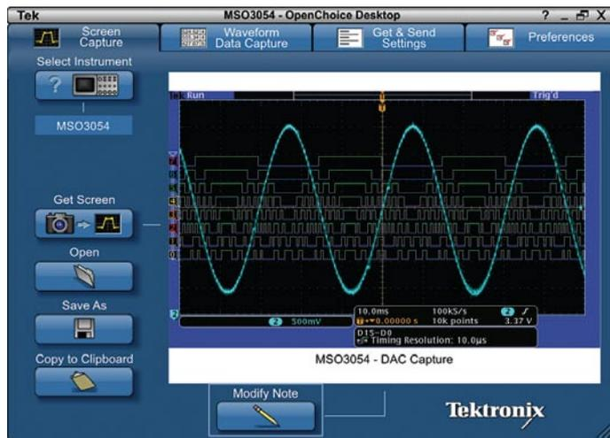
ПО OpenChoice® Desktop обеспечивает совместную работу осциллографа с компьютером.
