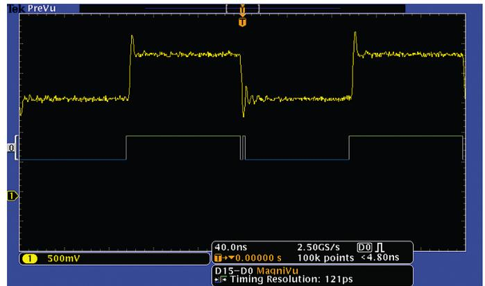
Режим быстрого захвата MagniVu обеспечивает разрешение по времени 121,2 пс, позволяя выполнять точные измерения временных характеристик цифровых сигналов.
