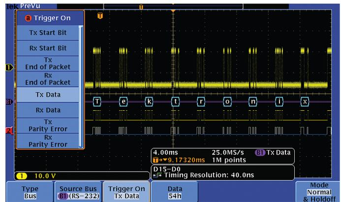
Захват: запуск по конкретному пакету данных, передаваемому по шине RS-232. Полный набор функций запуска, включая запуск по содержанию пакета последовательных данных, позволяет быстро захватывать интересное событие.
