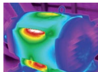
Аномальный неравномерный нагрев двигателя
