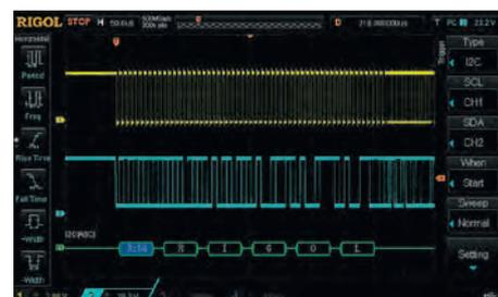
Рис. 13. Запуск по последовательным шинам (тип шины I<sup>2</sup>C)
