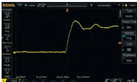
Рис. 7. Измерение полосы пропускания по скорости нарастания
