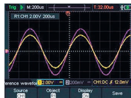
Рис. 9. Загруженная опорная осциллограмма в осциллографах серии ADS-204x
