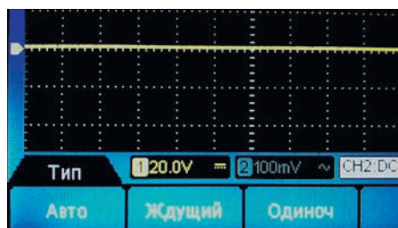
Рис. 6. Выбор типа запуска в осциллографах серии ADS-204x
