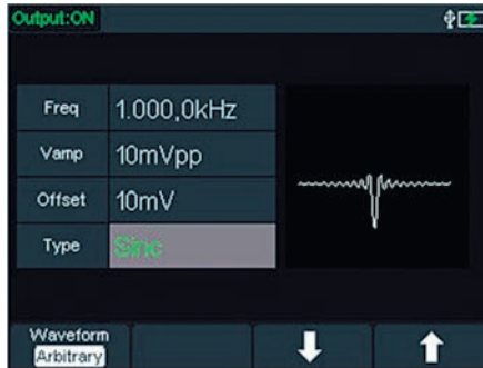
Рис. 12. Дисплей ADS-204x в режиме установки параметров генератора
