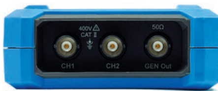
Рис. 13. Выходной разъем генератора в осциллографах ADS-2045, ADS-2047, ADS-2049
