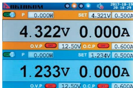
Рис. 2. Дисплей источника питания APS-5333
