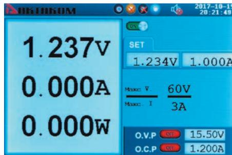
Рис. 6. Дисплей источника питания APS-5333 при последовательном соединении каналов
