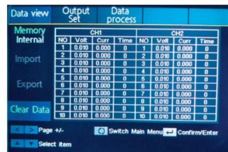
Рис. 9. Меню управления режимом работы «по списку», вкладка Data View
