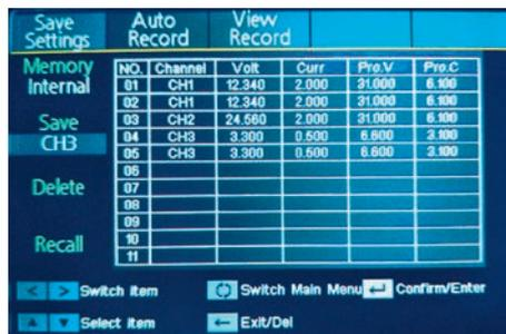
Рис. 12. Меню режима сохранения. Вкладка Save Settings сохранения параметров каналов
