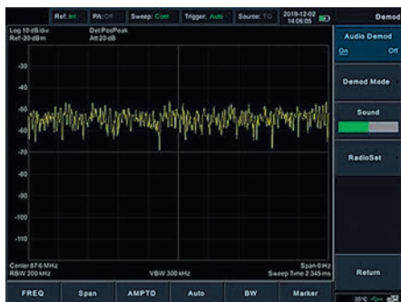
Рис. 7. Экран функции демодуляции (демодуляция аудио)
