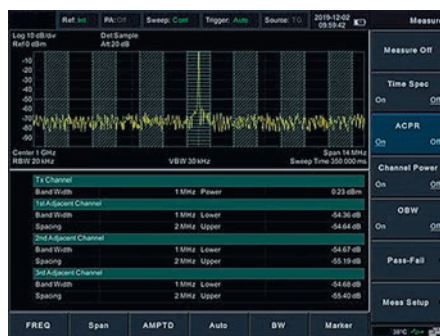
Рис. 10. Экран прибора при включенной функции измерения мощности в смежных каналах
