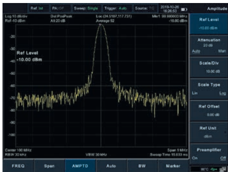
Рис. 3. Экран прибора, видны верхнее, правое боковое и нижнее функциональное меню
