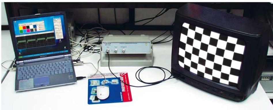
Рис. 1. Генератор измерительных телевизионных сигналов АНР-3126
