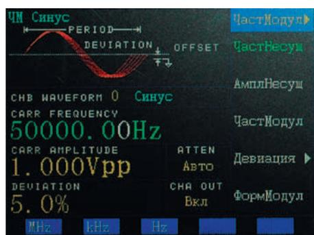
Рис. 6. Графический дисплей генератора АНР10х1
