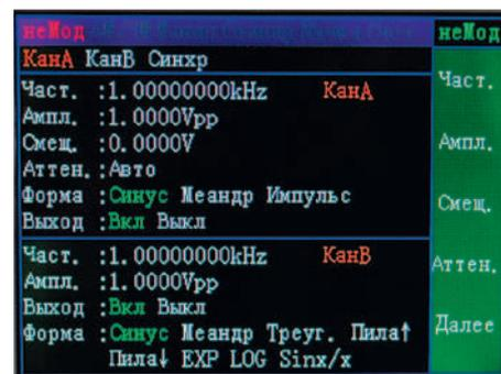
Рис. 2. Экранное меню управления генератором АКТАКОМ
