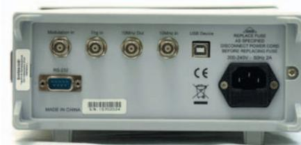
Рис. 12. Задняя панель генератора сигналов с высокой точностью задания частоты АКТАКОМ АНР-1016
