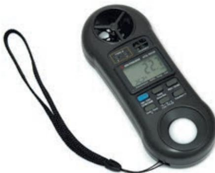
Рис. 22. Измерение влажности и температуры воздуха
