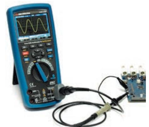
Рис. 6. АММ-4189 в режиме осциллографа
