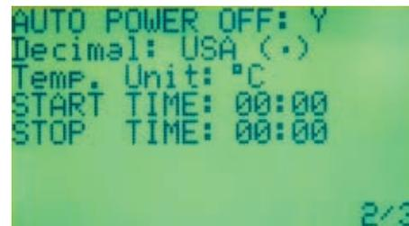
Рис. 17. Установка параметров режима регистратора данных
