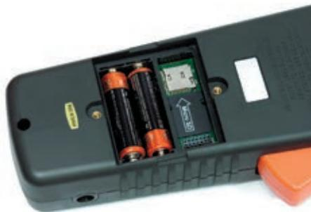
Рис. 16. Отсек для батарей и micro SD
