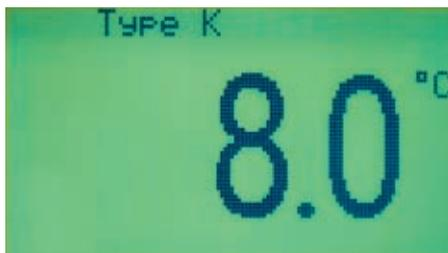
Рис. 15. Дисплей ACSM-2159 в режиме измерения температуры
