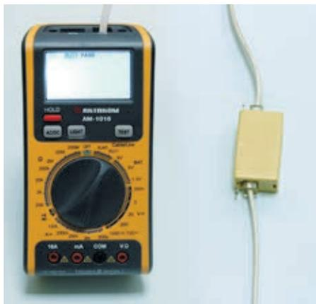
Рис. 9. Тест телефонной линии
