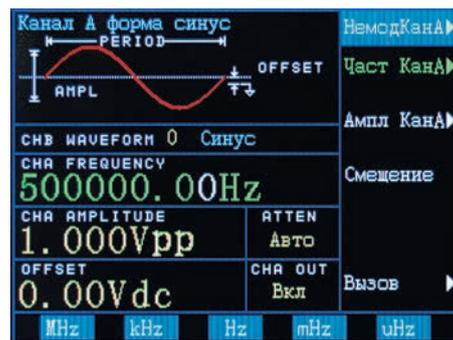
Параметры сигнала генератора
