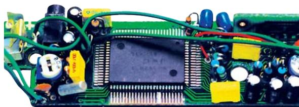
Рис. 4. Размещение микросхемы NJU 9207F в мультиметре M-3211D
