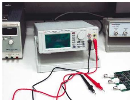
Рис. 7. Программируемый цифровой мультиметр АМ-1041
