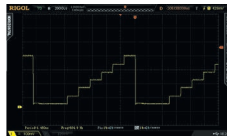
Рис. 10. Режим Hi-Res в осциллографе RIGOL DS2102A помогает подавить шум в сигнале даже при однократном захвате
