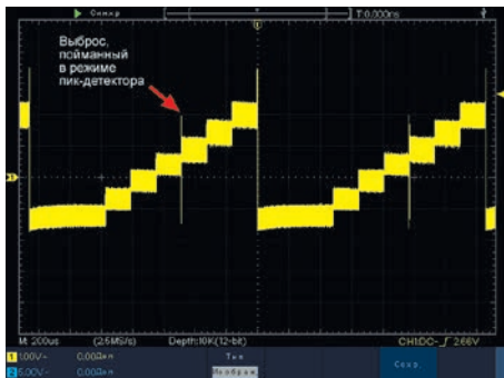
Рис. 5. Регистрация зашумленного сигнала осциллографом АКТАКОМ ADS-6122H в режиме «пик-детектора», зафиксированы выбросы высокой амплитуды и повышенный уровень ВЧ-шумов
