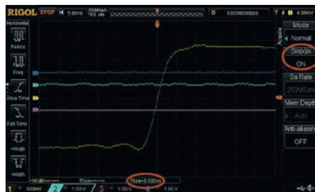
Рис. 17. Измерение скорости нарастания фронта тестового сигнала (исходное значение 6 нс) осциллографом RIGOL DS1074Z в режиме интерполятора \sin(x)/x ; результаты измерения дают близкое к исходному значению величину – 6,1 нс
