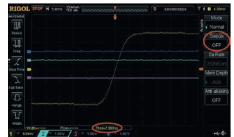
Рис. 16. Измерение скорости нарастания фронта тестового сигнала (исходное значение 6 нс) осциллографом RIGOL DS1074Z в режиме линейного интерполятора (sin(x)/x выключен); результаты измерения дают заметную ошибку — 7,9 нс
