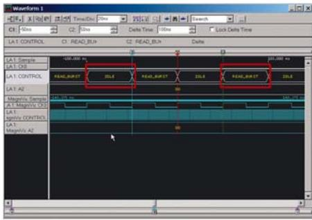
Рис. 11. Символьное отображение данных в окне осциллограмм
