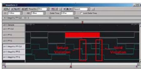
Рис. 8. Детектирование нарушений условий установления удержания
