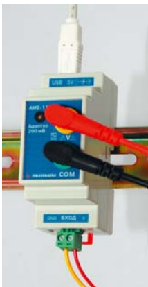
Рис. 1. Модули выполнены в стандартном электротехническом корпусе и могут крепиться на DIN-рейку
