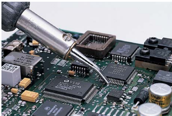
Монтаж SMD - корпусов с помощью наконечника "миниволна"
