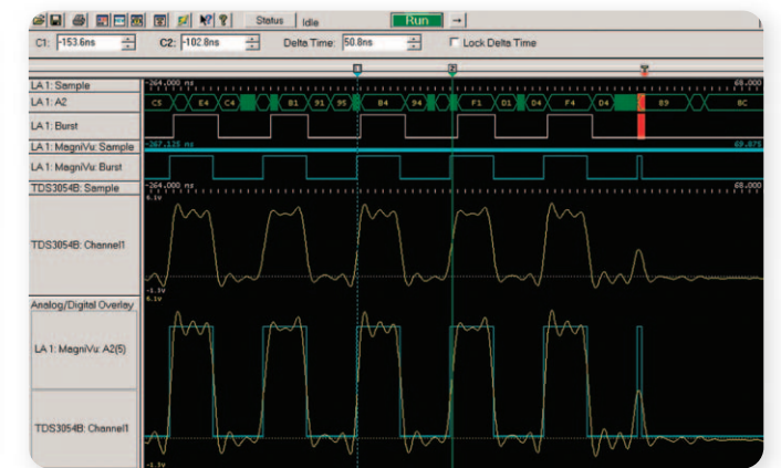
► Рис. 5. Анализ временных параметров с использованием логического анализатора Tektronix TLA.
