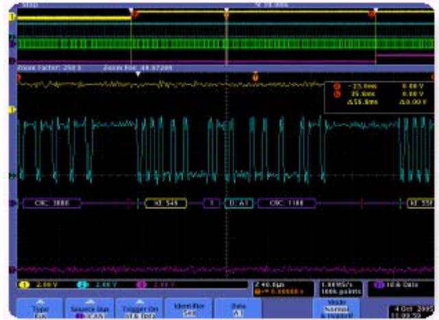
► Рис. 16. Запуск по определенному идентификатору и кадру данных в шине CAN, и декодирование всех сообщений в зарегистрированной осциллограмме.
