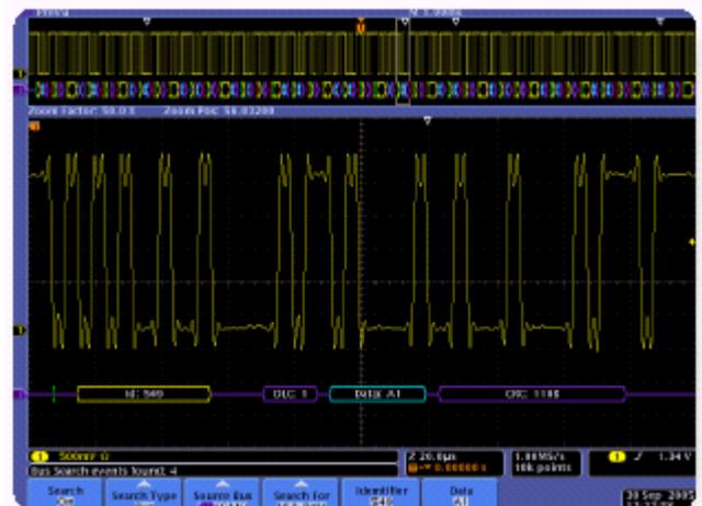
► Рис. 18. Поиск по определенному идентификатору и данным в зарегистрированной осциллограмме шины CAN.
