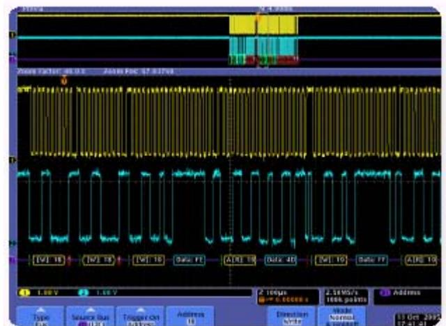
► Рис. 7. Декодирование осциллограммы адресной линии и линии данных I<sup>2</sup>C.
