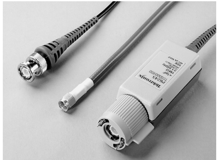
Рис.2.5. Высоковольтные пробники могут измерять постоянные напряжения до 20 кВ и импульсы до 40 кВ в полосе 75 МГц.
