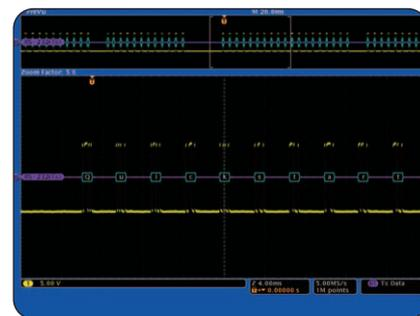
► Запуск на определенный пакет данных, который передается по шине RS-232. На дисплее отображения шины представлено содержимое декодированного пакета в коде ASCII
