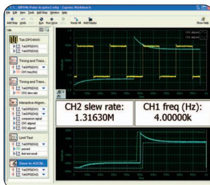
► NI LabVIEW SignalExpress™ Tektronix Edition (SIGEXPTE) – программное обеспечение для полностью интерактивного сбора данных, измерений и анализа, разработанное совместно с компанией NI и оптимизированное для осциллографов серии 4000.
