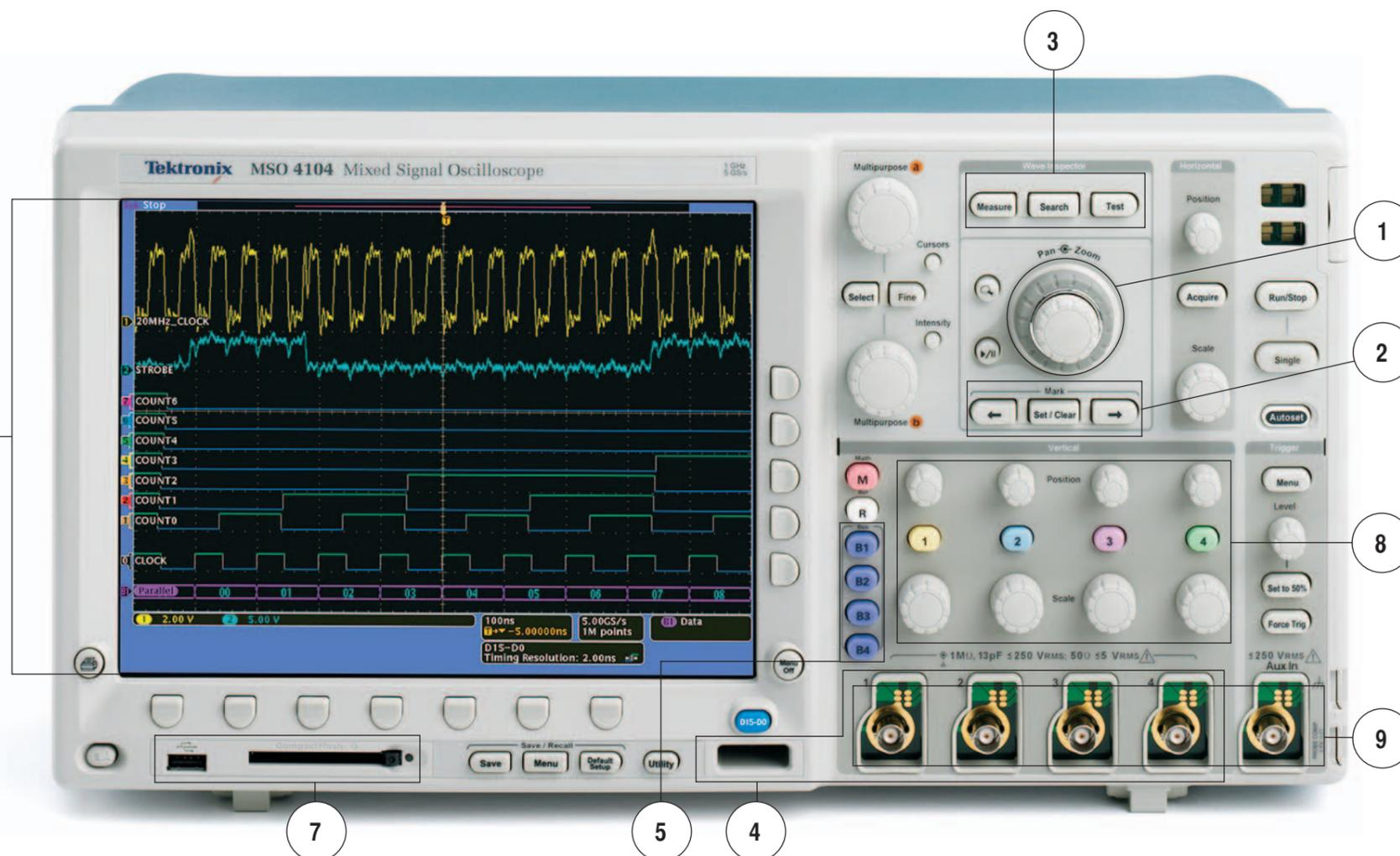
**1 Масштаб и просмотр.** Для масштабирования и просмотра выделены специальные ручки на передней панели. Внутренняя ручка предназначена для управления коэффициентом масштабирования, а внешняя ручка – для перемещения окна масштабирования по осциллограмме. Перемещаться по осциллограмме становится совсем просто.
