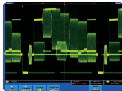
► Просмотр видеосигнала NTSC. Следует отметить возможность просмотра сигнала с различной яркостью, благодаря которой осциллограф с цифровым люминофором серии 4000 может представлять на экране время, амплитуду и распределение амплитуды во времени.
