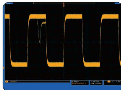
► Высокая скорость сбора осциллограмм позволяет обнаруживать и захватывать источники трудноуловимых глитчей и другие редкие события.
