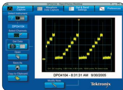
► OpenChoice® Desktop – стандартное программное обеспечение для быстрого подключения осциллографа к ПК.
