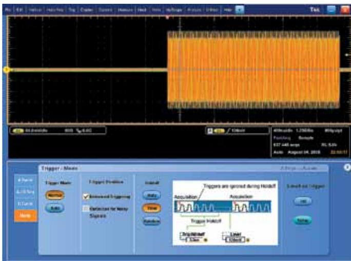
Разнообразные функции запуска осциллографа позволяют захватывать только те фрагменты сигнала, которые вас интересуют. Функции системы запуска Pinpoint, такие как сочетание событий А и В с запуском по фронту и удержанием, позволяют захватывать последовательности импульсов в конкретных режимах работы передатчика.
