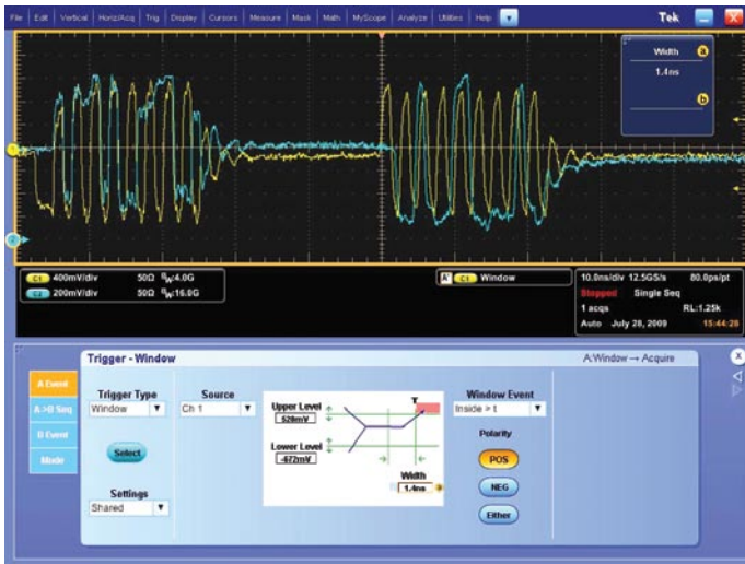
Figure 7. Using « Window » trigger to identify DQS Write Preamble.
