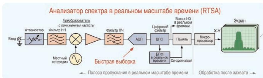
► Рис. 10. Упрощенная блок-схема анализатора спектра в реальном масштабе времени — оцифровка ПЧ и цифровая обработка данных. Благодаря высокой частоте дискретизации анализатор RSA3408A обеспечивает разрешение по времени 20 нс или ширину полосы пропускания в реальном масштабе времени 36 МГц.
