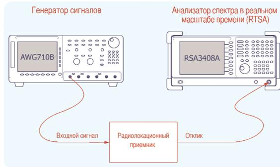
► Рис. 21. Прибор AWG710B может использоваться для генерации сложных радиолокационных сигналов, предназначенных для наблюдения и измерения с помощью анализатора спектра RSA3408A.
