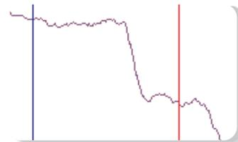
► Аналоговый сигнал с частотой дискретизации до 20 Гвыб/с, зарегистрированный на осциллографе и переданный на экран логического анализатора; по нему можно определить причины выброса.
