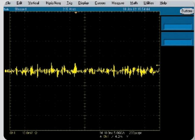
► **Колесания в шине заземления**
